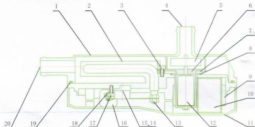
Рис. 1 Схема конструкции подогревателя
